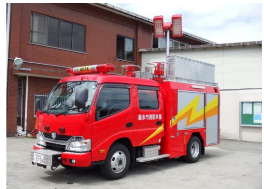
電源照明車 (日野 H24 年購入)
