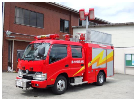
電源照明車 (日野 H24 年購入)
